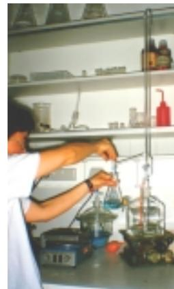
Fig 5.1 Titrimetric determination of Ca<sup>2+</sup>-ions
